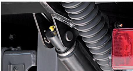
Cilindro hidráulico con **tubo protector** o **fuelle** (de serie) como protección frente a desprendimientos de piedras y a la corrosión.
