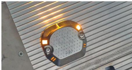
Resistente luz intermitente LED **CargoFlash** (de serie) con gran intensidad de luz y muy buena capacidad de radiación lateral con poco consumo energético.
