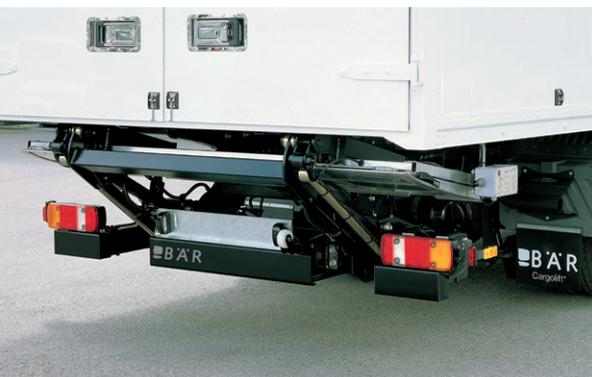
El BC 1500 F2, desplegable manualmente con unas dimensiones compactas del plato, ofrece 1500 kg de capacidad de carga y los platos de aluminio de hasta 1510 mm de profundidad. Como todos los Cargolifts de la serie Falt, el BC 1500 F2 también permanece en la rampa de forma imperceptible debajo del vehículo y entra en servicio rápidamente en cuanto se requiere.
