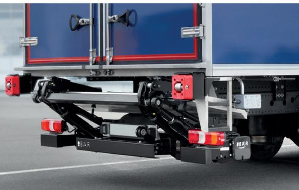
La capacidad de carga de 1500 kg y los platos de una altura de hasta 1510 mm son también características del BC 1500 F4. En contraste con la variante F2, éste ofrece una compensación de la inclinación en toda posición en altura por medio de dos cilindros inclinadores. Ello aumenta, además de la comodidad del manejo, la seguridad.
