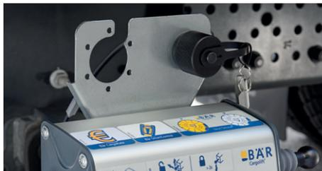
**Interruptor de llave eléctrico externo** (opcional) para el montaje en el soporte de la caja de mando. Impide un manejo no autorizado alternativo a la SwitchKey.
