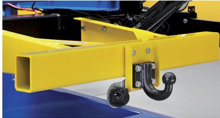
**Soporte para enganche de bola** (opcional) con autorización europea de servicio de componentes (ABE de piezas), valor D 26,9 kN, carga de apoyo máx. 250 kg, peso aprox. 25 kg. ¡Se requiere una preinstalación eléctrica en el vehículo! **Bola de remolque** suministrable opcionalmente.
