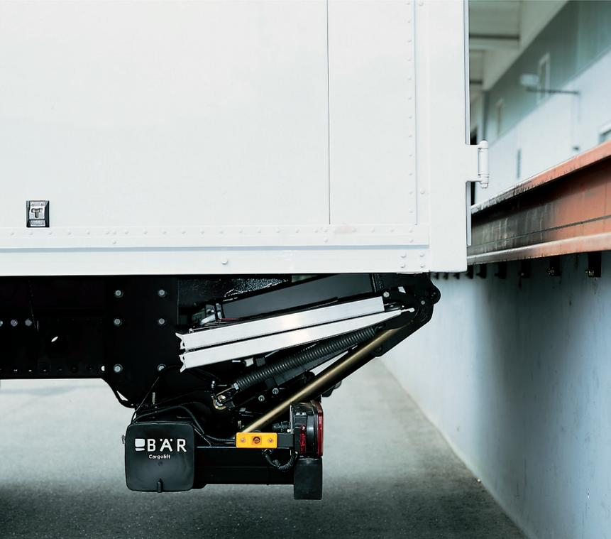
¿Necesita frecuentemente tener acceso libre a las puertas de la caja del camión, por ejemplo para una carga y descarga en la rampa? ¿Le estorbaría un plato Standard al usar el vehículo? Entonces el Bär Cargolift Falt es su solución para las tareas de carga cuando así lo requiera.
