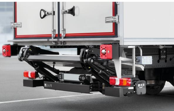
El uso de rampa y el transporte de contenedores con ruedas son igualmente característicos del BC 1000 F4. En contraste con la variante F2, éste ofrece una compensación de la inclinación en toda posición en altura por medio de dos cilindros inclinadores. Ello aumenta, además de la comodidad del manejo, la propia seguridad.
