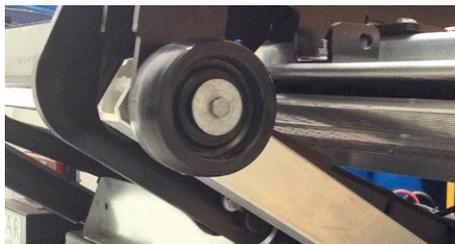
Los **rodillos para el suelo** (de serie) protegen el plato de la abrasión mecánica por contacto con el suelo.
