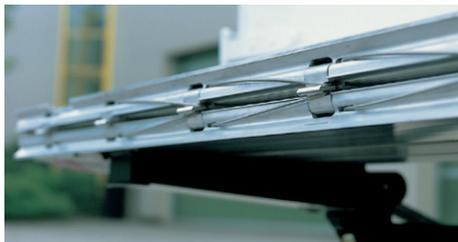
**Plegado** manual del paquete y de la punta del plato con descarga de peso **por resorte** (de serie).
